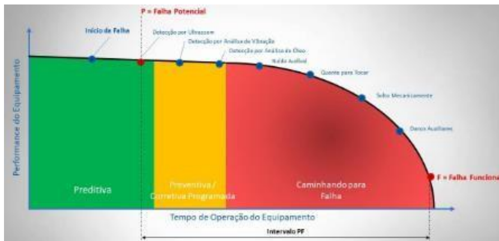
Figura 01 – Curva Potencial de Falha (PF)
