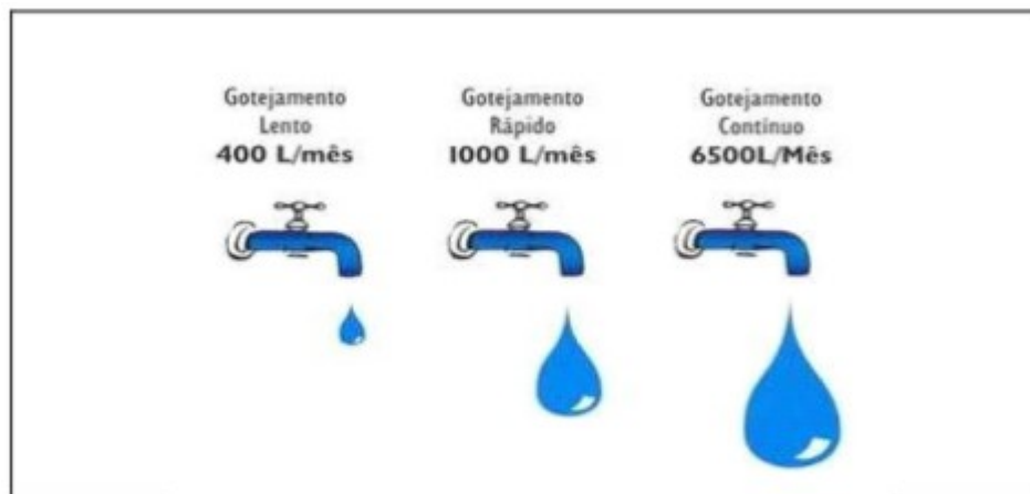
Figura 2. Níveis de gotejamento em torneiras com vazamento
